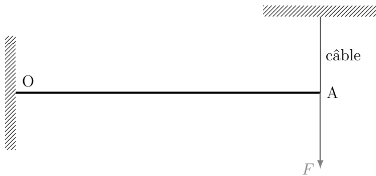
FIGURE 4 – Représentation schématique de la poutre et du câble de suspension.
